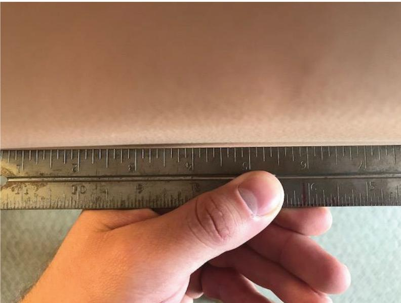
Photo d'une règle utilisée pour évaluer la planéité du mur.
